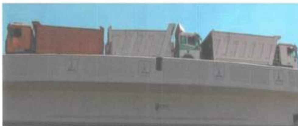
شكل رقم (5-4): أماكن عربات التحميل على الباكية المختبرة أثناء مراحل التحميل المختلفة
