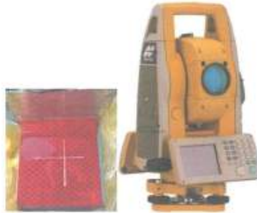
شكل رقم (٣-١): جهاز محطة الرصد المتكاملة المستخدم لقياس الترخيم والعاكس أسفل الكميرات
